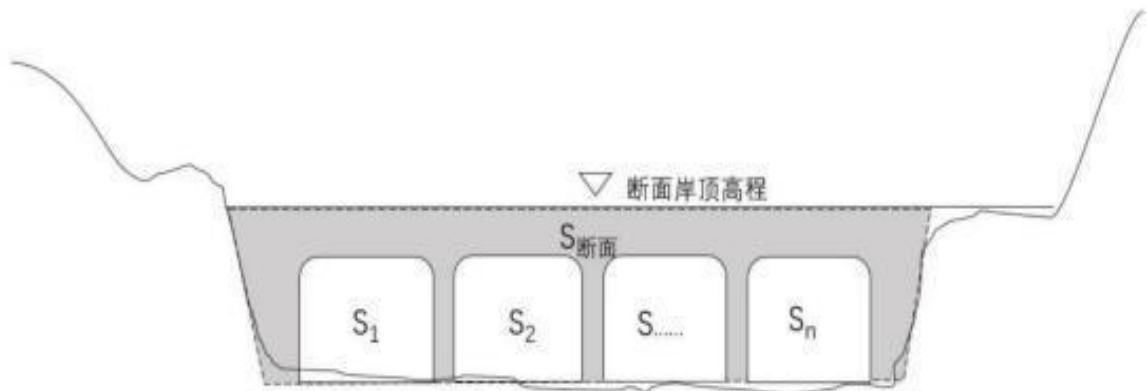
(b) 横断面及其概化（圆形结构物）
